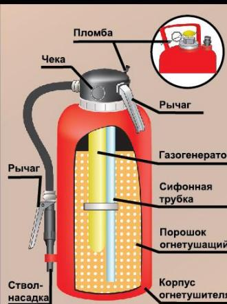
Устройство имеющее заряд огнетушащего вещества со встроенным источником давления (газогенератор) в режиме ожидания находится без давления.
